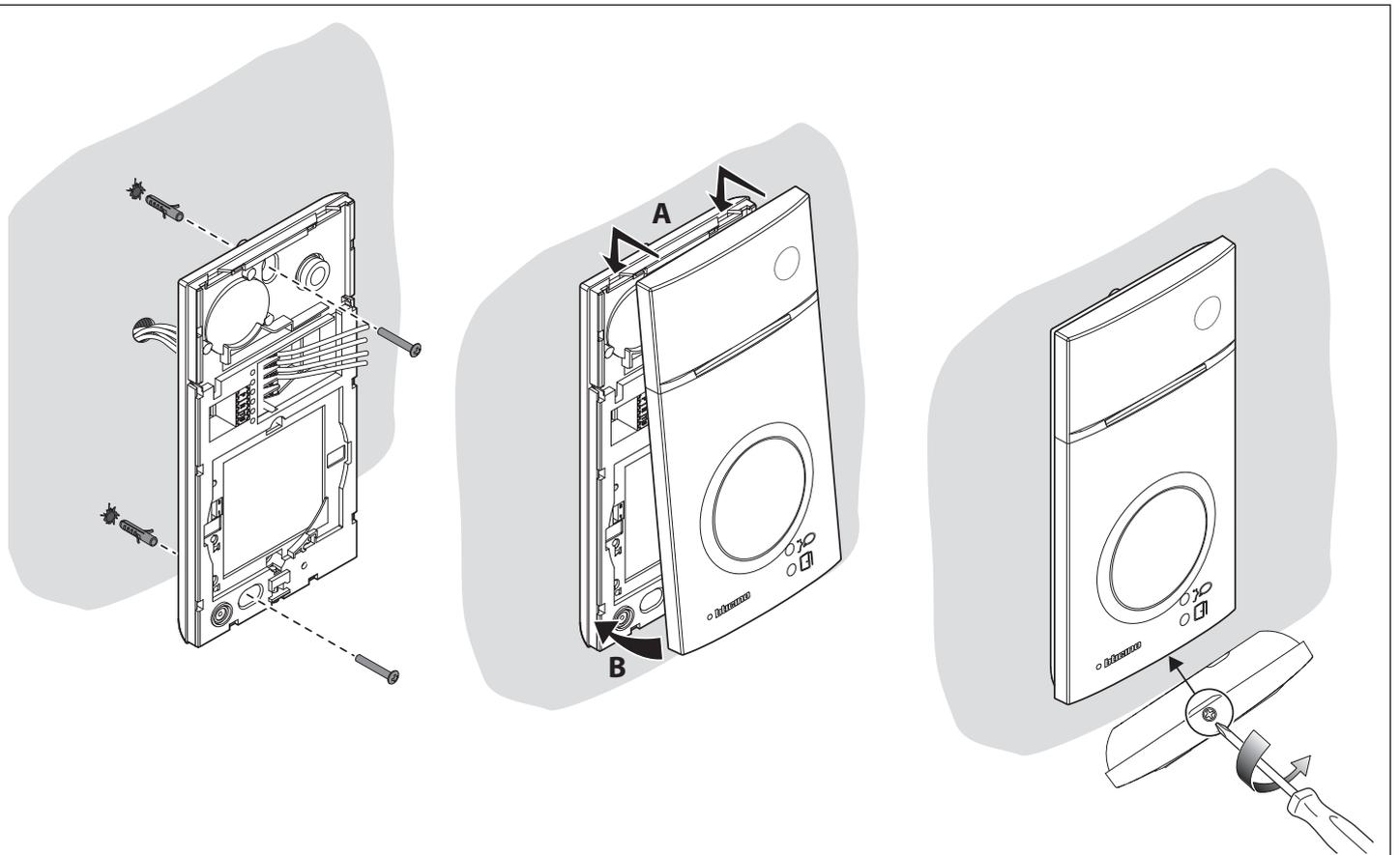
**A** - Prima dell'installazione assicurarsi che la vite sia completamente avvitata.
